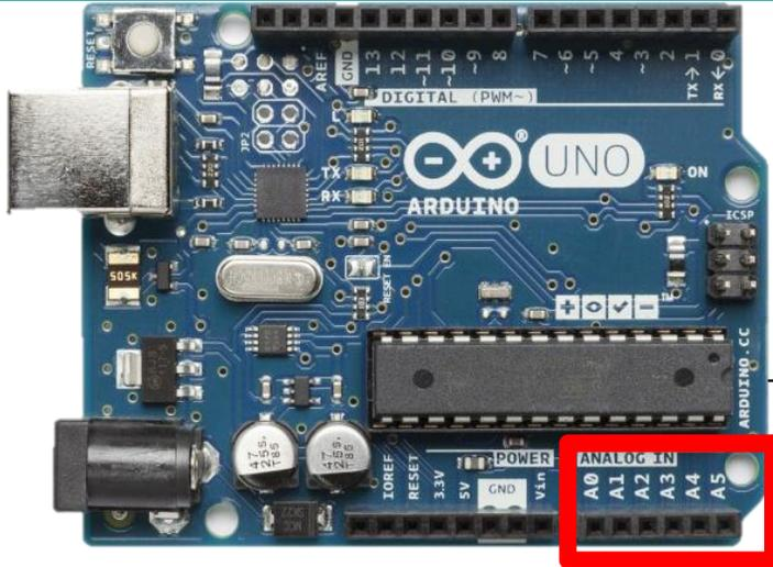
Une entrée analogique est un voltmètre. Le microcontrôleur ne travaille cependant qu'avec des nombres binaires, il est alors utilisé un convertisseur analogique numérique (CAN).
