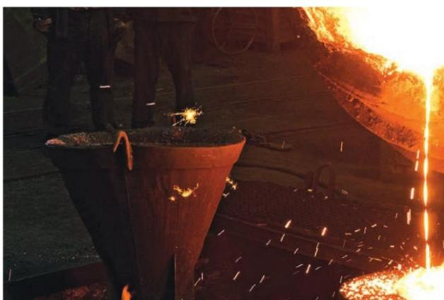
On chauffe  $m = 10$  tonnes de fer dans un four électrique afin d'obtenir du fer liquide à  $1\,535^{\circ}\text{C}$ .
