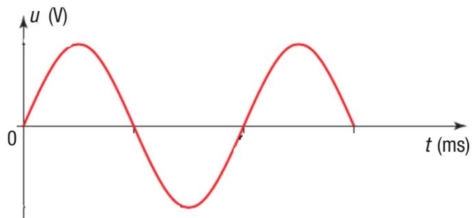
Un voltmètre peut aussi mesurer une tension périodique en utilisant un des calibres V~ (mode AC)
