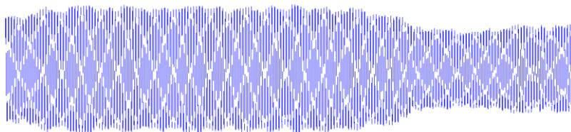
Une fois la partie à analysée sélectionnée, cliquer sur **Traiter**. Répondre Non si Regressi demande un enregistrement préliminaire. Le graphe du signal sélectionné s'affiche. On peut mesurer la période à l'aide l'Outil **Réticule libre** (voir ci-contre)
